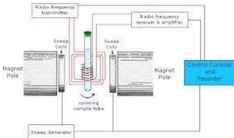
**Fig11. NMR Instrumentation**[27].
